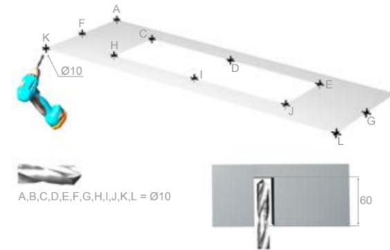
Taladre los agujeros con una broca de 10 mm utilizando los puntos (A, B, C, D, E, F, G, H, I, J, K, L) marcados en la plantilla de instalación donde se instalará el dispositivo. La profundidad del agujero debe ser como mínimo de 60 mm.
