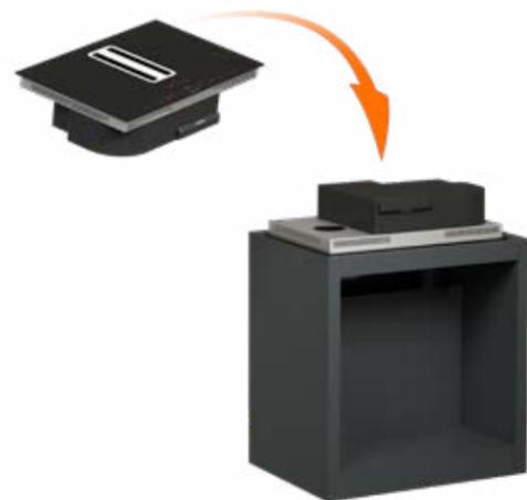
Antes de colocar su producto en la encimera, coloque el producto boca abajo sobre la encimera para unir materiales de sellado y aislamiento térmico.
